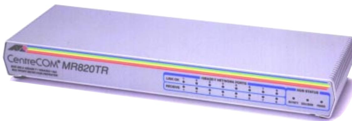
CentreCOM MR820TR は、10BASE-Tポートを8ポート装備した HUB です。ネットワークバックボーンポート（ステーションポート）として、AUI（10BASE5）インターフェース及び 10BASE2 インターフェースを使用できます。ポート毎にセグメント障害検出機能を持ち、障害が検出されたセグメントを自動的にネットワークから切り放し、1セグメント上の障害がシステム全体の障害（システム・ダウン）とならない保護機能を有しています。セグメントの状態表示用 LED により障害の発生しているセグメントの切り分けや、セグメント上のトラフィックの把握等が容易に行えます。また、ツイストペア・ケーブルの誤配線（極性逆接続）検出、自動訂正（本装置内部で極性反転を行う）機能により、配線を修正することなしに通信を行うことが可能です。
