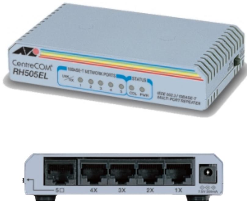
CentreCOM RH505EL は 10BASE-T を 5 ポート装備した外部電源型ミニ HUB です。超コンパクトなシガレットサイズでオプションのマグネット Kit を使用して壁面や机の側面に取り付けることもできます。カスケード接続ポート(MDI/MDI-X 切替え)により、ストレートケーブルによるカスケード接続も可能です。SOHO 環境はもちろんワークグループにおける PC の増設などに幅広く活用できます。
