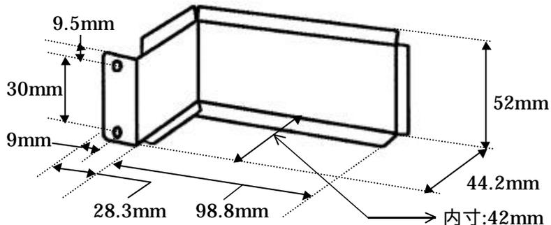
材質：冷間圧延鋼板
