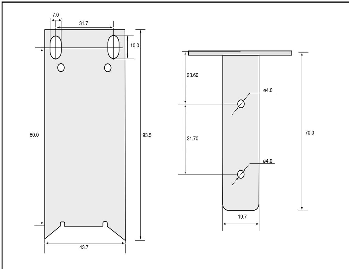
図2：外形寸法(単位 = mm)
