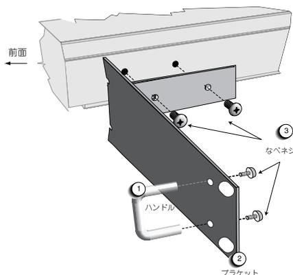
図 1: ハンドルおよびブラケットの取り付け方
