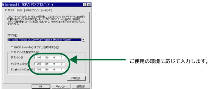
図 3.2.13 Microsoft TCP/IP のプロパティ (IP アドレス設定画面)
