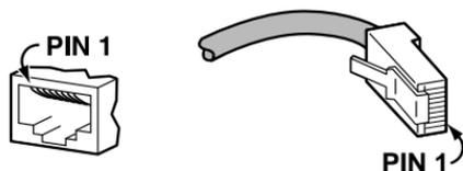
図 A.2.1 RJ-45 モジュラージャック / プラグ外観図
