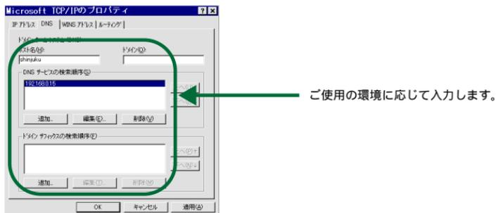
図 3.2.14 Microsoft TCP/IP のプロパティ (DNS 設定画面)
