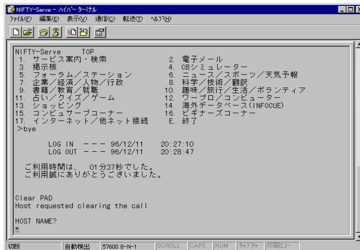
この段階では電話回線との接続はまだ切断されていません。電話回線を切断するには HOST NAME? のあとに OFF と入力して下さい。ターミナルウィンドウ左下の 接続 の欄が 切断 の表示に変わります<sup>††</sup>。
