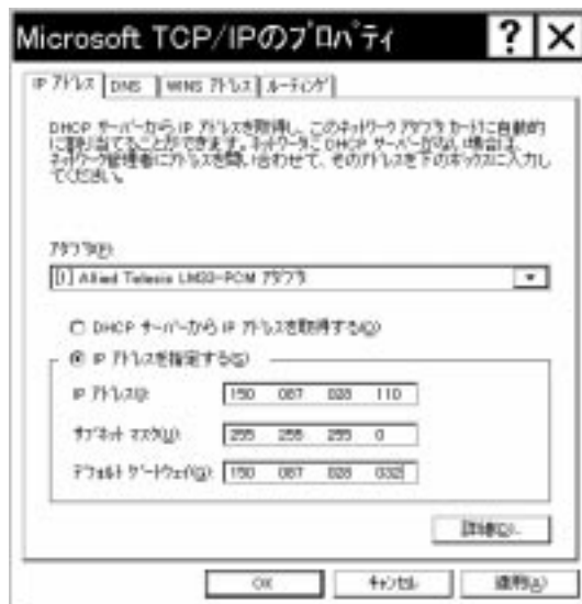
画面 1.23 TCP/IP のプロパティ (IP アドレス)
