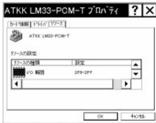
画面 1.4 モデムの I/O 範囲 (I/O Base Address=2F8h)
