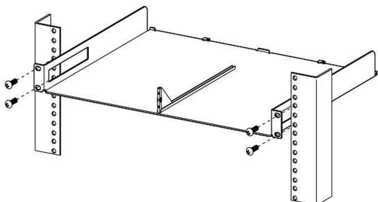
図 1 19 インチラックへの取り付け
