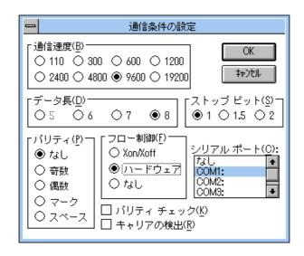
3. [設定]メニューから[端末の設定]を選択すると、「端末の設定」ダイアログボックスが表示されます。下図のように設定して、「OK]ボタンをクリックします。
