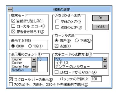
4 [設定]メニューから[端末エミュレーション]を選択すると、「端末エミュレーションの選択」ダイアログボックスが表示されます。下図のように設定して、[OK]ボタンをクリックします。
