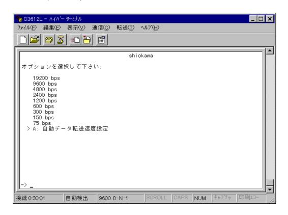
「A: 自動データ転送速度設定」を選択すると、自動ボーレートが設定されます。 自動ボーレートでは、マネージメントソフトウェアの起動時に回キーを 2、3回押すこと によって、ボーレートが自動的に設定されます。
