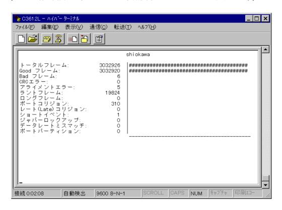
「Hub全体」画面は、本体全体の動作概要をグラフ表示します。棒グラフによって、全体のネットワークの動作状況が一目で分かるようになっています。 それぞれのカウンタ値は、グラフ左側に表示されます。
