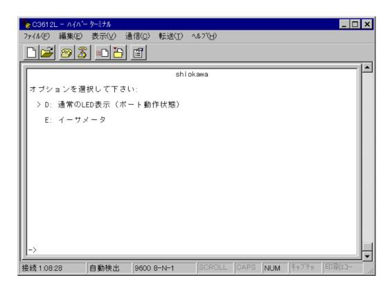
ここでは、本体前面の PORT ACTIVITY LEDを、10BASE-Tポートの動作状態を表示する LEDとして使用するか、ネットワーク負荷を表示するイーサメータとして使用するかを 選択することができます。
