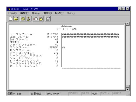
選択したポートの動作概要をグラフ表示します。棒グラフによって、選択したポートのネットワークの動作状況が一目で分かるようになっています。 それぞれのカウンタ値は、グラフ左側に表示されます。
