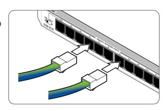
ネットワークに接続する端末に、 10BASE-Tネットワークインター フェイスカードが正しく取り付けて あることを確認し、UTPケーブルの もう一方を端末のネットワークイン ターフェイスカードに接続します。
