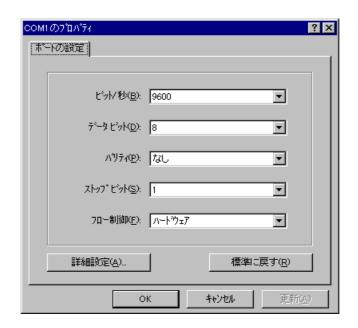
5. 「XXXX-ハイパーターミナル」のような、先ほどの設定した名称のウィンドウが表示されます。[ファイル]メニューの中から[プロパティ]を選択すると、「XXXXのプロパティ」ダイアログボックスが表示されます。[設定]タブを下図のように設定して、「OK]ボタンをクリックします。
