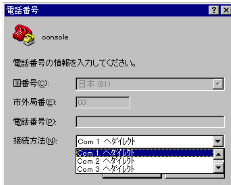
図 4.1.7 「ハイパーターミナル」の通信設定
