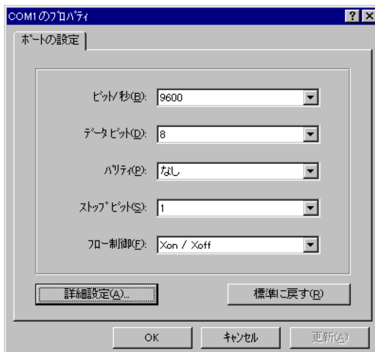
図 4.1.8 「ハイパーターミナル」のポートの設定
