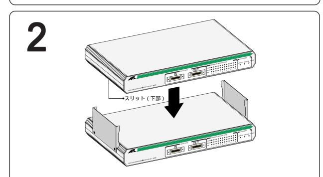
FH908TX/S・912TX/Sの左右側面にしっかりとスタックプレートが接続されていることを確認した後、スタックするもう一台のFH908TX/S・FH912TX/Sのスリット(下部)にスタックプレートの上部を差し込むように入れ、スタックプレートの凹み部分がスリットに引っかかるようにはめ込みます。その際、スタックしたFH908TX/S・FH912TX/S同士の位置が、極端にずれないようにしてください。
