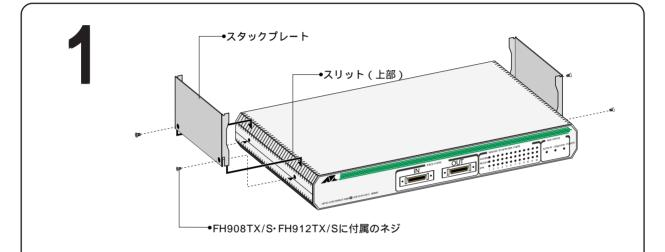
FH908TX/S・912TX/Sの側面に付属しているネジを取り外し、スタックプレートのネジ用の穴と、FH908TX/S・FH912TX/Sのネジ穴の位置を確認しながら、スタックプレートをスリット(上部)に差し込むように入れ、スタックプレートの凹み部分がスリットに引っかかるようにはめ込みます。その後、付属のネジでしっかりとネジ止めしてください。
