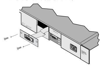
(4) スライドキットを止めている平頭ネジ(マイナス)をはずし、コネクタ部分とコネクタプレートをはずします。(はずしたネジ、ナット類は保管しておきます。)
