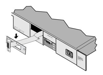
(2) 添付の (保管してあった) ネジ、ナットとスライドキットを使用して、AUIコネクタとコネクタプレートを組み立てます。
