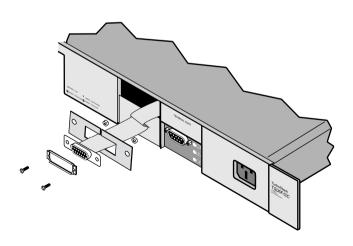
(3) 左右の黒い皿ネジを使用してAUIポートを取り付けます。 (本体側のネジ部はやわらかいので、強く締めすぎないようにします。)
