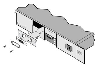
(5) ケーブルをコネクタプレート上部のスリットを通して、はずします。 (軽くひねると、スリットを通過させることができます。)
