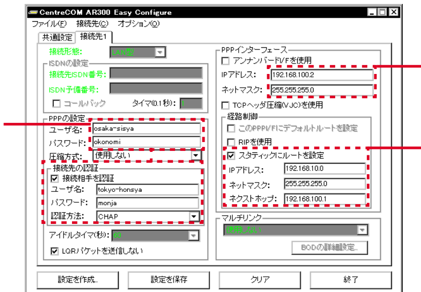
図 7.2.4 : 接続先 1 (専用線による 2 拠点接続・OSAKA)
