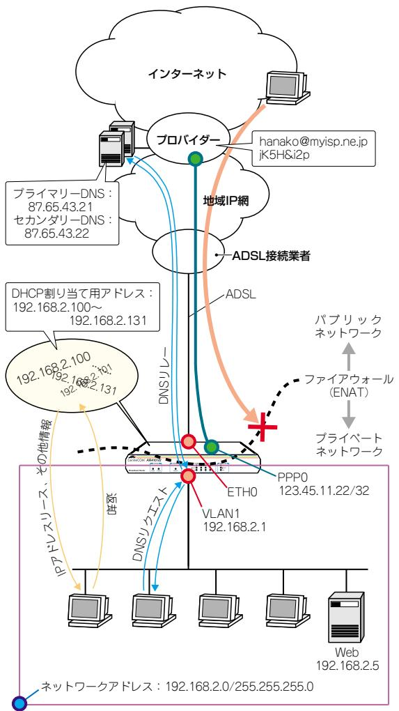
図 5.4.1 PPPoE による端末型の接続 (IP1)
