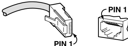
図 A.5.3 RJ-48 モジュラープラグ（左）、ジャック（右）
