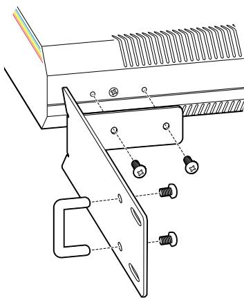
図2.2.1 プラケットの取り付け
