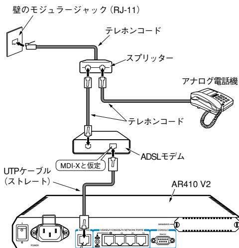
図2.3.1 ADSL モデムの接続
