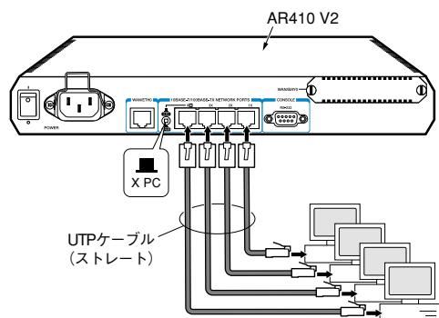
図2.3.3 コンピューターの接続
