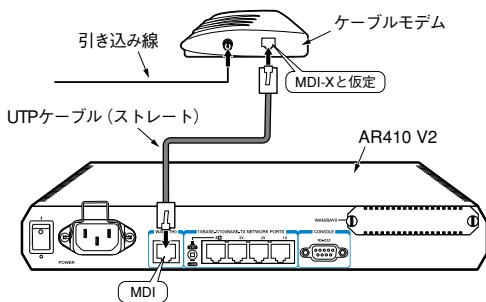
図2.3.2 ケーブルモデムの接続
