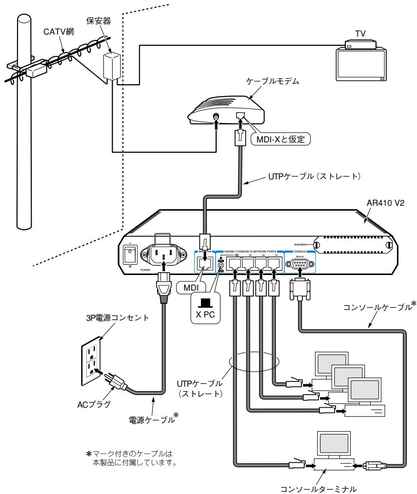
図 2.1.2 ケーブルモデムを使用した基本的なネットワーク構成例
