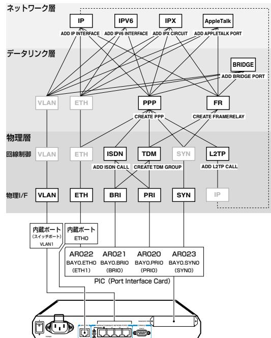
図4.4.1 インターフェースの階層構造
