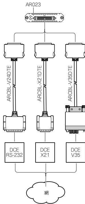
図 A.5.16 AR023 と各専用ケーブルの接続
