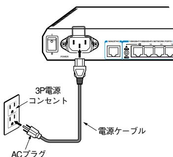
図2.3.6 電源ケーブルの接続
