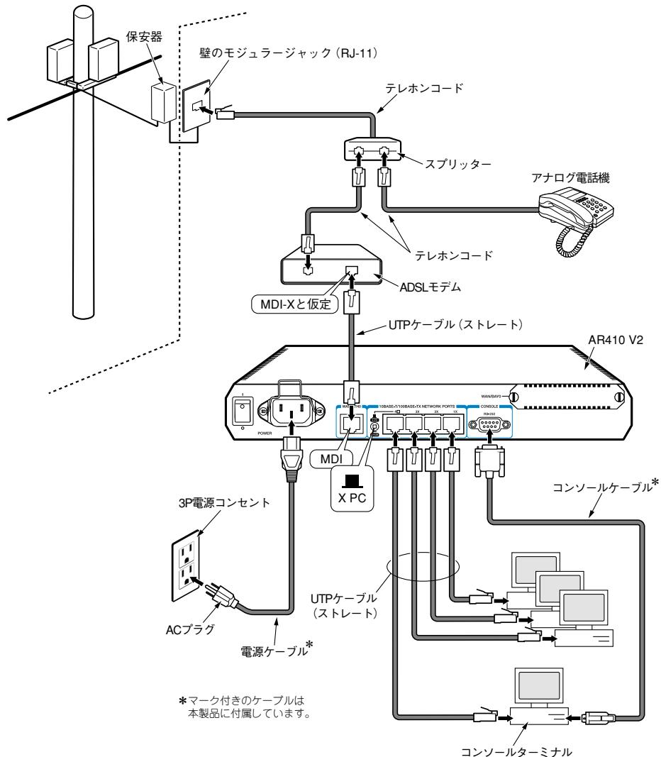
図 2.1.1 : ADSL モデムを使用した基本的なネットワーク構成例
