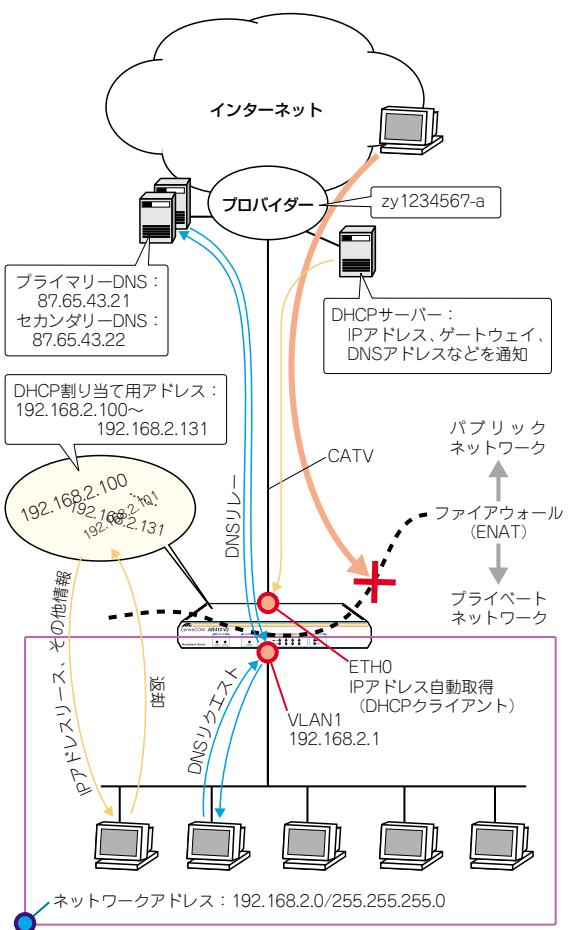
図 5.2.1 CATV による端末型の接続
