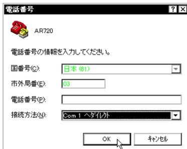
図 3.1.4：「接続方法」に本製品のコンソールケーブルが接続しているポート名を選ぶ
