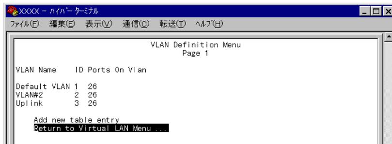
以上で、3つのVLANの定義が終了しました。ポート26をDefault VLANとVLAN#2に重複して登録することにより、ポート26がタグ付きポートであることを明示します。次にポートを各VLANに割り当てます。
