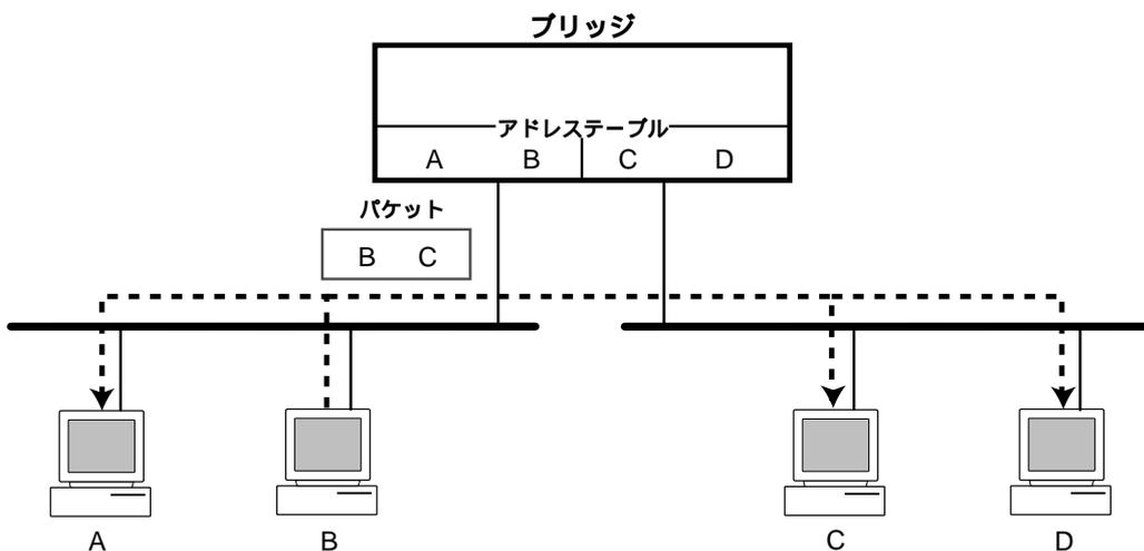
ブリッジは受信したデータを一度 RAM 上に記憶しておきます。そして反対側のポートの回線が送信できる状態のとき(他の端末が送信していないとき)に反対側にフォワードします。
