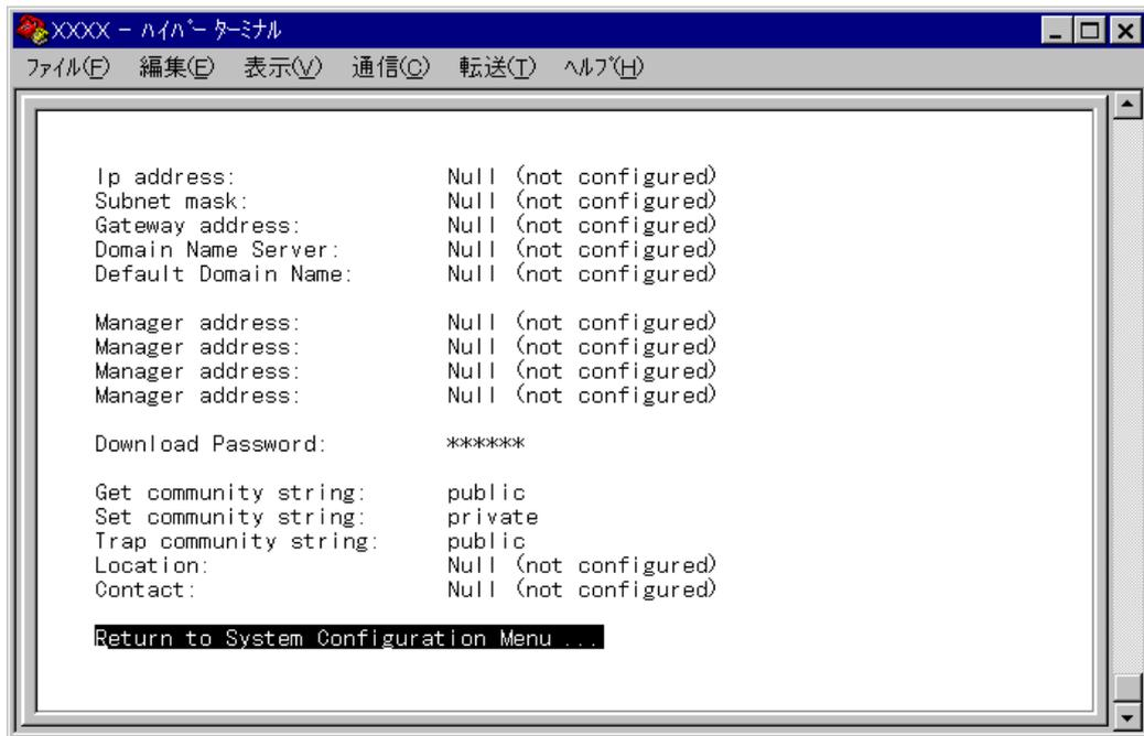
この画面では、SNMP や Telnet でシステムを管理するための IP パラメータオプションが表示されます。SNMP や Telnet を使用する場合は、最低、IP アドレスとサブネットマスクの設定が必要となります。
