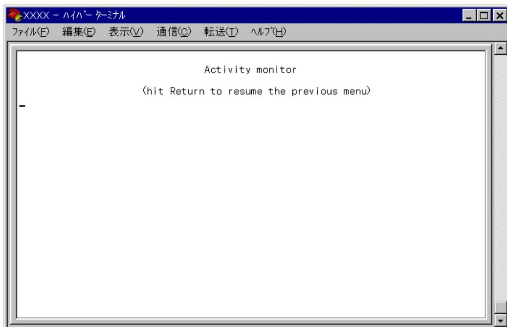
この画面では、システム上の動作がメッセージ(英数字)で表示されます。ポートの接続、ソフトウェアのダウンロードやPingテストなど、システムで進行中の動作を監視して、トラブルシューティングとして利用することができます。
