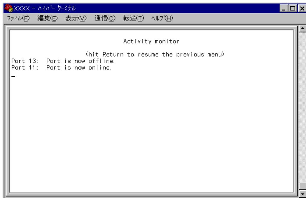
「Activity monitor」画面を表示させたまま、ポート13にリンクしているケーブルを抜くと、ポート13のリンクが切断され、「Port 13: Port is now offline」というメッセージが表示されます。
