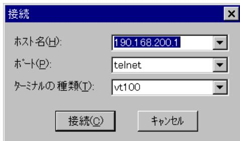
Windows 2000/XP の場合 - 次のコマンドを入力して、Enterキーを押します。OPEN に続けて本製品の IP アドレスを指定します。
