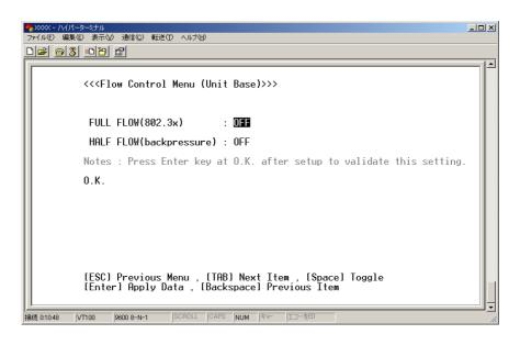
フローコントロール機能とは、同一スイッチ内で受信ポートの転送速度が送信ポートの転送速度を上回る場合や、受信したパケットの送出が特定のポートに集中する場合などに、バッファーのオーバーフローによるパケットロスを未然に防ぐための機能です。バッファーメモリーを監視し、空きが減少してくると、Half Duplex 時はジャム信号を、Full Duplex 時はシャム信号を、Full Duplex 時はシャム信号を、Full Duplex 時はシャムを受信ポートから送出し、接続機器からの送信を一時的に停止させることで、フロー制御を行います。
