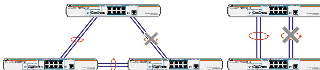
▶ 本製品は、同一機種同士のトランク接続が可能です。その他のトランク接続が可能な弊社製品については、弊社ホームページの「製品 / 動作検証リスト」でご確認ください。
