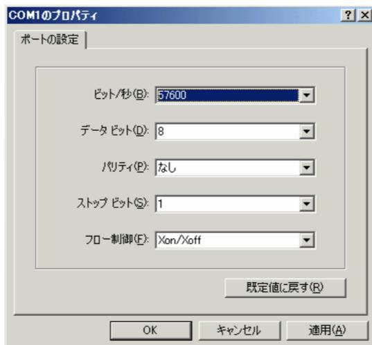
6. ハイパーターミナルからファームウェアを送信します。ハイパーターミナルの[転送]メニューから[ファイルの送信]を選択してください。ファイル名にはファームウェアのファイル名を入力し、プロトコルは[Zmodem]を選択します。[送信]をクリックしファームウェアの送信を開始します。バージョンアップが完了するまで絶対に電源を切らないでください。フラッシュへの書き込み中に電源を切ると、製品が起動できなくなる可能性があります。
