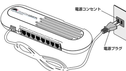
図 4 電源ケーブルの接続
