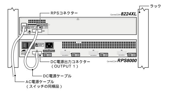
DC電源ケーブルを接続した時点で、スイッチ前面のRPS LED(緑)が点灯します。
