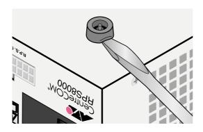
3 本体側面にブラケットを合わせ、ブラケット用ネジで両側にしっかりと固定します。
