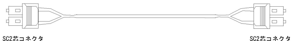
図 3-9 1000BASE-LH 用シングルモード光ファイバケーブル（コア径 8\mu\text{m} ）の概略図
