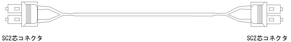
図 3-6 1000BASE-SX / 1000BASE-LX 用マルチモード光ファイバケーブル（コア径 50 \mu\text{m} ）の概略図
