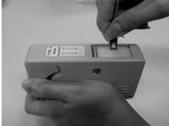
図 A-4 フェルール端面の清掃
