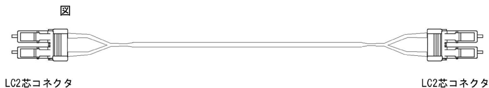
図 3-17 10GBASE-LR 用シングルモード光ファイバケーブル（コア径 10\mu\text{m} ）の概略
