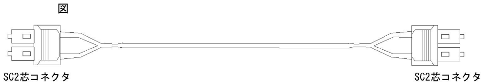
図 3-12 10GBASE-LW 用シングルモード光ファイバケーブル（コア径 10 \mu m）の概略
