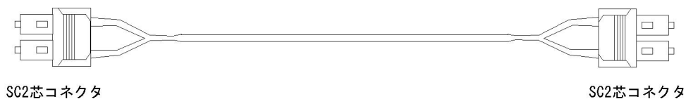
図 3-7 1000BASE-SX / 1000BASE-LX 用マルチモード光ファイバケーブル (コア径 62.5\mu\text{m} ) の概略図
