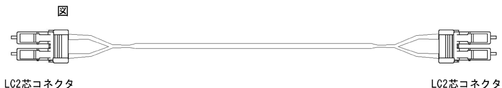
図 3-15 10GBASE-ER 用シングルモード光ファイバケーブル（コア径 10\mu\text{m} ）の概略
