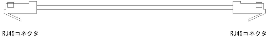
図 3-23 ツイストペアケーブル（ストレートケーブル）の概略図
