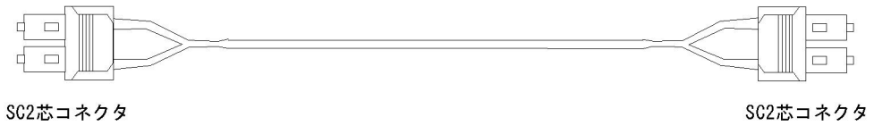
図 3-10 10GBASE-ER / 10GBASE-EW 用シングルモード光ファイバケーブル（コア径 10 μm）の概略図
