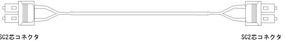
図 3-8 1000BASE-LX / 1000BASE-LH 用シングルモード光ファイバケーブル (コア径 10\mu\text{m} ) の概略図
