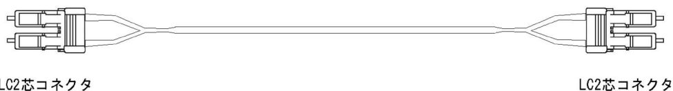
図 3-19 OC-48c POS 用シングルモード光ファイバケーブル (コア径 10 \mu\text{m} ) の概略図
