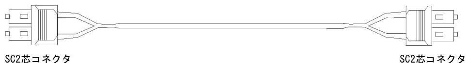
図 3-2 1000BASE-SX / 1000BASE-LX マルチモード光ファイバケーブル（コア径 50\mu\text{m} ）の概略図
