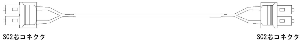
図 3-4 1000BASE-LX / 1000BASE-LH シングルモード光ファイバケーブル (コア径 10 \mu m) の概略図
