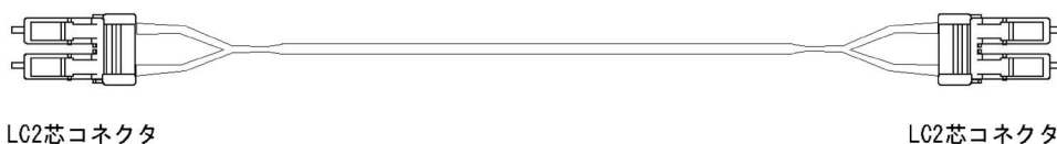
図 3-9 1000BASE-LH シングルモード光ファイバケーブル（コア径 8\mu\text{m} ）の概略図
