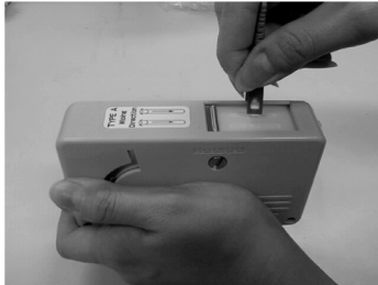
図 A-4 フェルール端面の清掃
