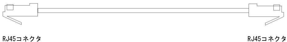
図 3-16 ツイストペアケーブル（ストレートケーブル）の概略図
