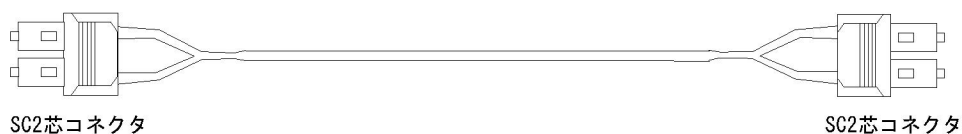
図 3-3 1000BASE-SX / 1000BASE-LX マルチモード光ファイバケーブル（コア径 62.5 \mu\text{m} ）の概略図
