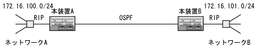
図 12-51 サブネット間の接続の例
