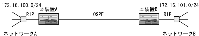
図 8-51 サブネット間の接続の例
