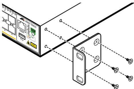
3 ラックに付属のネジを使用して、19インチラックに本製品を取り付けます。
