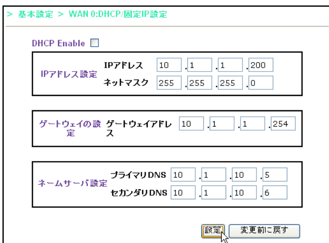
図 7.2.1 WAN0 DHCP/Static IP 設定画面 (Static)
