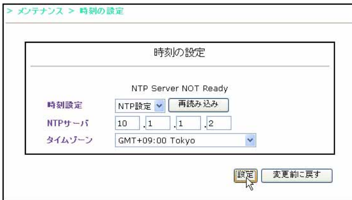
図 12.2.1 NTP サーバーの設定
