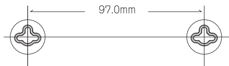
図 2.4.5 タッピングスクリュー（壁面設置穴）の間隔
