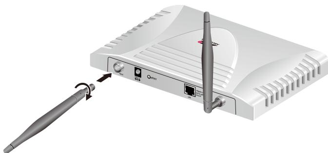
図 2.3.1 アンテナの取り付け
