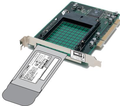
図 5.1.0.1 正しい取り付け方向
