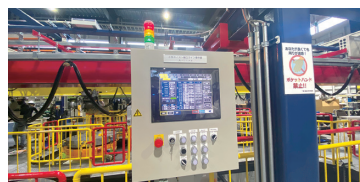
▲ 工場内ホイスト検査 操作盤
