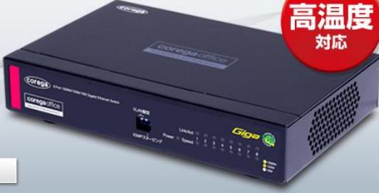
本商品は、全ポートギガビットイーサネット(1000BASE-T/100BASE-TX/10BASE-T)に対応した8ポートスイッチングハブのマルチプルVLANポートベースVLAN/高温度/メタル筐体/電源内蔵対応モデルです。省エネ機能として「しっかり節電機能」を搭載、環境やコストに配慮した設計となっています。ネットワーク上のデータ転送効率を向上させる「Jumbo Frame 9,216Byte」にも対応、ギガビットイーサネットの性能を最大限に活かした高速・大容量通信が可能で、光回線とのネットワーク構築に最適です。静音・高耐久のファンレス設計でありながら動作環境温度50°Cまで対応し、高温環境下でも設置が可能です。電源部には信頼の日本メーカー製電解コンデンサを採用することでオフィスネットワークに向けた高信頼性を実現しました。
