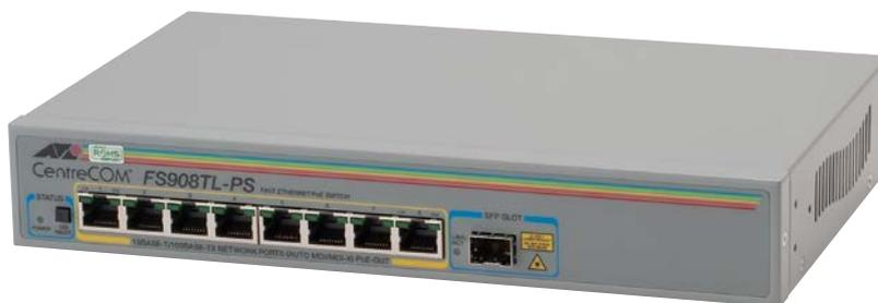
CentreCOM FS908TL-PSは10BASE-T/100BASE-TXポート(自動認識)を8ポート装備し、全ポートがIEEE 802.3af 準拠の Power over Ethernet 給電機能に対応したファーストイーサネット・PoE・スイッチです。
