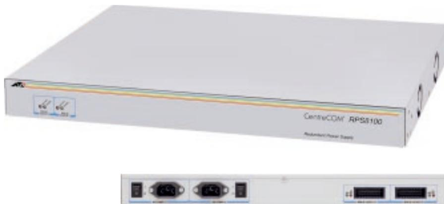
CentreCOM RPS8100は、CentreCOM 8224SL用のリダンダント電源装置です。スイッチ本体に内蔵されている電源が故障した場合、本製品によりスイッチ本体は動作を続けることが可能です。また、本製品の電源とスイッチ本体の電源を別系統の電源ラインから供給させることで、サーキットブレーカーの遮断などによる商用電源の供給停止に対応することができます。高さが1Uサイズ(44mm)の筐体なので、19インチラック搭載のスペースを節約できます。
