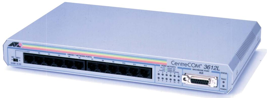
CentreCOM 3612L は、コストパフォーマンスに優れたSNMP 機能付き 12 ポート・インテリジェントHUB です。また、バックボーンのネットワーク接続用に10BASE5 (AUI) を装備しています。ファンレスのコンパクトなA4サイズですので、机の上や机の側面への設置も容易で、SOHO環境へのSNMP管理環境導入に最適です。
