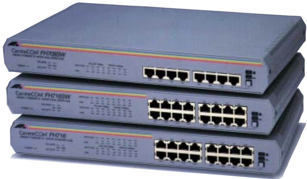
CentreCOM FH700シリーズは、10BASE-T/100BASE-TX自動認識ポートを8/16ポート搭載したデュアルスピードのファーストイーサネットスタッカブルHUBです。10Mbpsと100Mbpsの混在環境を簡単に低コストで構築できます。各ポート毎に自動的に10BASE-Tと100BASE-TXの速度を認識し、それぞれのコリジョンドメインを内部で構成します。FH708SW/FH716SWはこれら2つのドメインの10Mbps-100Mbps間通信機能(ブリッジング)を装備したモデルです。FH716はこれらSWモデルとスタックすることによって安価にデュアルスピードポートを増設できるスタック専用モデルです。
