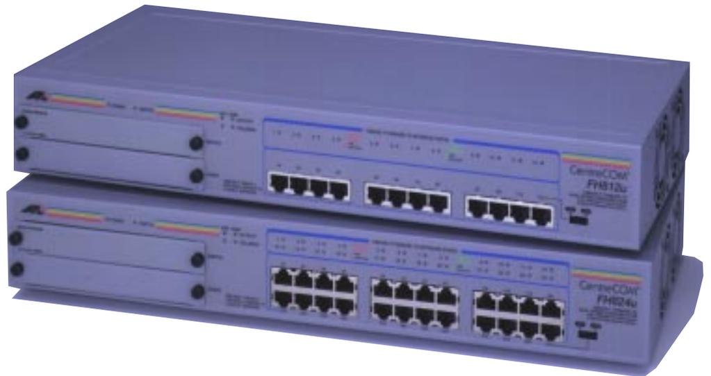
CentreCOM FH812u-SW / FH824u-SW は、10BASE-T/100BASE-TX 自動認識ポートを搭載したデュアルスピード・HUB です。10Mbps と 100Mbps の混在環境を簡単に低コストで構築できます。各ポート毎に 10/100Mbps を自動検知し、バンドルされている FH802u の内部スイッチ機能により、10Mbps セグメントと 100Mbps セグメントを相互接続することが可能です。また、追加の管理モジュール (CentreCOM FH801u : 別売) をスロットに差し込むことにより、SNMP 管理に対応したデュアルスピードのインテリジェント HUB として動作します。
