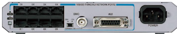
CentreCOM MR820TRX は、10BASE-T インターフェースを 8 ポート装備した、軽量・小型で電源内蔵型のイーサネット・HUB です。バックボーンポートとして AUI (10BASE5)、BNC (10BASE2) を装備し、10BASE-T と同時に使用できるため、多様なネットワーク構築が可能となります。また、豊富な設置用オプションを利用することでスチール製の机や壁面、および 19 インチラックへの取り付けが可能となります。
