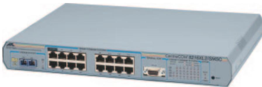
CentreCOM 8216XL2/SMSCは、10BASE-T/100BASE-TXポートを15ポートと、シングルモード光ファイバー対応の100BASE-FX(SCコネクタ)ポートを1ポート装備したファーストイーサネット・インテリジェント・スイッチです。最大15kmの長距離接続に対応した光ファイバーポートを装備することにより、FTTHや地域イントラネットなどのアクセススイッチとして効率的な設置が可能です。
