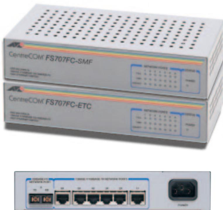
CentreCOM FS707FC-ETC/SMF は 10BASE-T/100BASE-TX × 6 ポートに加え、100BASE-FX(SC コネクタ)を 1 ポート標準装備したファーストイーサネットスイッチです。100BASE-FX ポートを装備しておりますので、通信距離の延長や光⇄UTP の変換などにご利用いただけます。また 60℃まで使用可能な熱対策設計を行っておりますので、使用条件の厳しい環境でもご利用いただけます。
