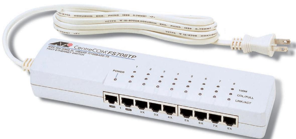
CentreCOM FS708TPは、10BASE-T/100BASE-TXポート(自動認識)を8ポート装備した、ファーストイーサネット・タップスイッチです。小型・軽量のプラスチックボディを採用した電源内蔵タイプです。また標準装備のマグネットや壁面取付けキットを使用することにより、場所を選ばず簡単に設置が可能。SOHOやデスクトップでの使用に最適です。
