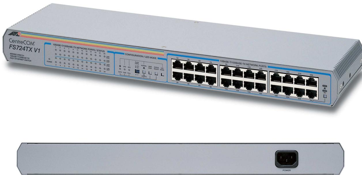
CentreCOM FS724TX V1 は、10BASE-T/100BASE-TX ポート (自動認識) を 24 ポート 装備したファーストイーサネット・スイッチです。複雑な設定は必要なく、既存の 10Mbps から 100Mbps ネットワークへの移行がスムーズに行えます。また、10/100M、Full/Half Duplex、Flow Control ON/OFF の手動設定を行うことが可能です。
