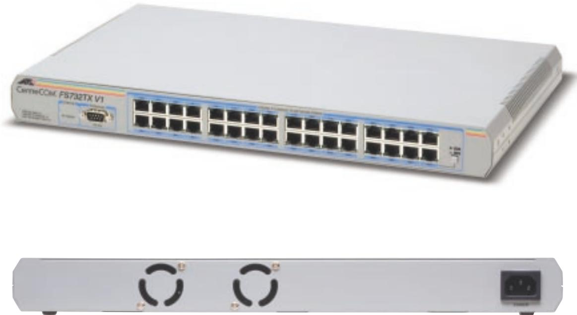
CentreCOM FS732TX V1 は、10BASE-T/100BASE-TX ポートを 32 ポート装備したファーストイーサネット・スイッチです。19 インチラックに設置した場合、1U(約 45mm)に収まるサイズなので、集線密度を上げることができます。本製品は VLAN/Trunking/QoS/Mirroring など、管理機能以外はインテリジェント・スイッチとほぼ同等の機能を備えています。特に VLAN に関してはマルチプル VLAN に対応していますので、互いに重複した VLAN グループを形成することも可能です。
