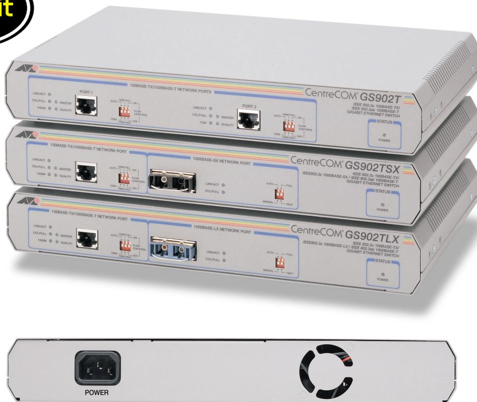
GS902Tは100/1000BASE-T×2、GS902TSX/TLXは100/1000BASE-Tと1000BASE-SX/LX GBICを装備した、2ポートのギガビットイーサネット・スイッチです。
