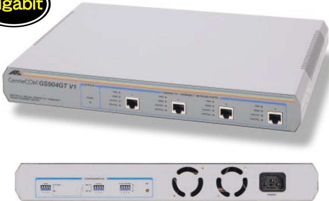
CentreCOM GS904GT V1 は 100BASE-TX/1000BASE-T ポートを 4 ポート装備したギガビットイーサネット・スイッチです。100Mbps/1000Mbps 対応のため、将来 1000Mbps にアップグレード予定のネットワークや、既存の 100Mbps と 1000Mbps ネットワークとの混在環境でも利用可能です。また、ディップスイッチにより、Half Duplex/Full Duplex (100Mbps 固定設定時のみ)、フローコントロール ON/OFF の手動設定を行うことができます。
