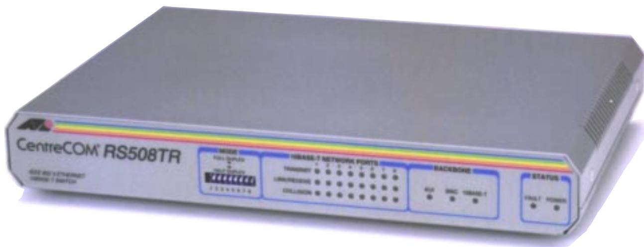
CentreCOM RS508TR は、10BASE-T スイッチポートを 8 ポートと 10BASE2/10BASE5 スイッチポート(切替え使用)を 1 ポート装備したイーサネット・スイッチです。
