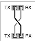
図6 光ファイバーケーブルの接続
