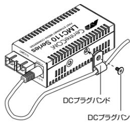
図8 電源ケーブルの固定
